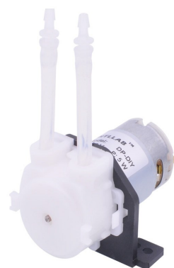
MA5522 BOMBA PERISTALTICA 12VDC -TUBO 3mmX5mm -100 mL/min -PUDE CONTROLAR EL SENTIDO DEL FLUJO SEGUN CONEXION.
